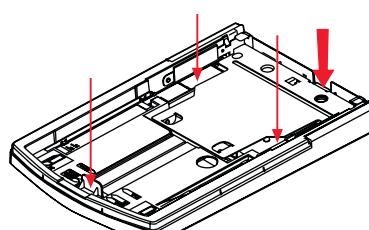
Press the platen in the paper tray until it locks down. Verrouillez la plaque du bac à papier en appuyant dessus. Presione la placa de la bandeja del papel hasta que se bloquee.
